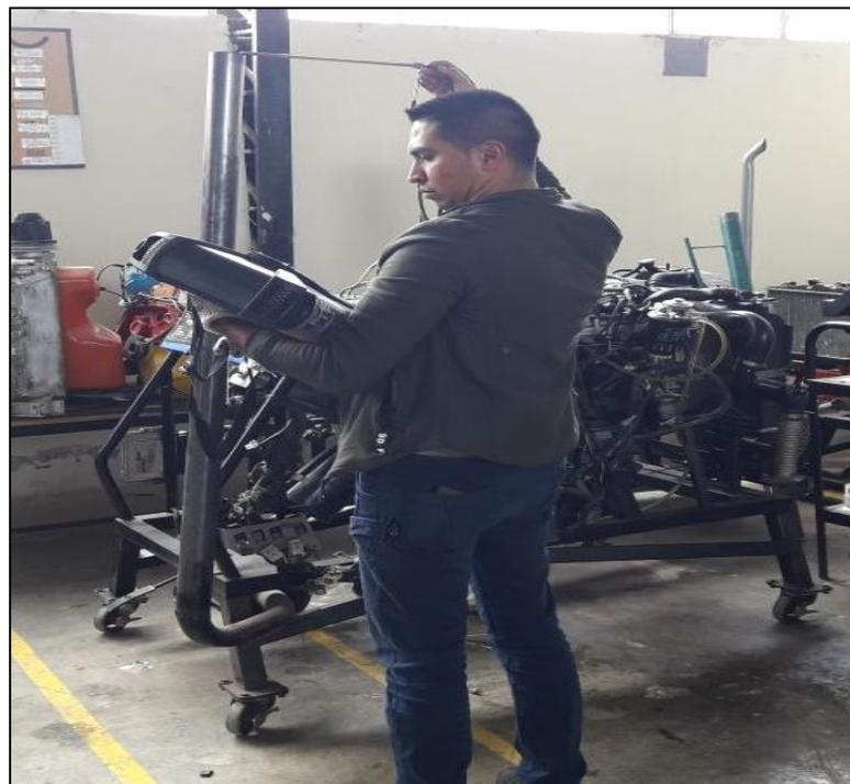
**Figura 3-5:** Análisis de gases en motor Mazda BT50
