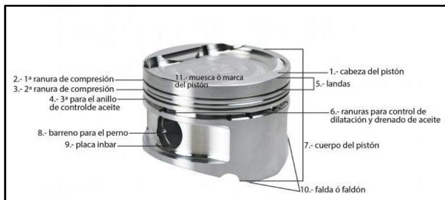
**Figura 2-5:** Partes de un pistón de motor de combustión interna.
