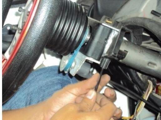
**Figura 3.10** Instalación del sensor de giro de volante.
