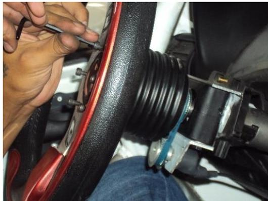
**Figura 2.24** Sensor Rotativo en la columna de dirección.
