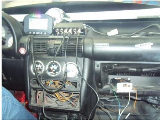
**Figura 3.7** Instalación de G dash.
