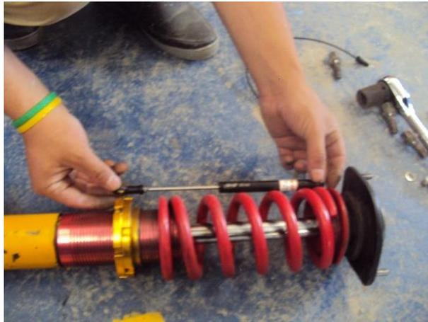
**Figura 2.22** Potenciómetro lineal.
