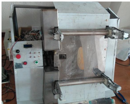
Figura 61. Colocación de planchas de acero inoxidable para laminado
