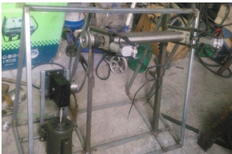
Figura 60. Montaje del motor y del motor reductor.
