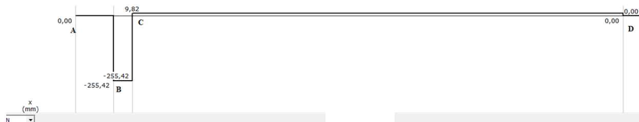
Figura 38. Diagrama de la fuerza cortante en el eje x - z .
