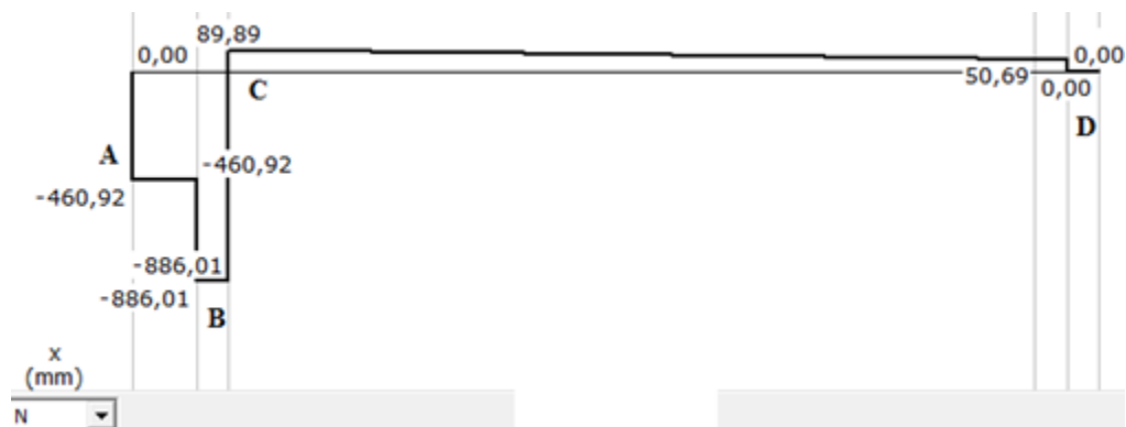
Figura 35. Diagrama de la fuerza cortante en el eje x - y .
