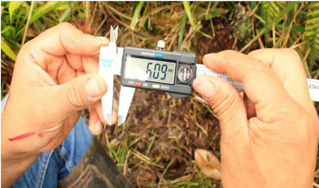
**Foto 10.** Calibrador electrónico
