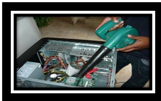
Figura 58. Limpieza con Aspiradora Autor: López Rolando
