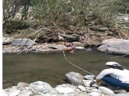
**Fotografía 2.** Medición de caudales en campo.
