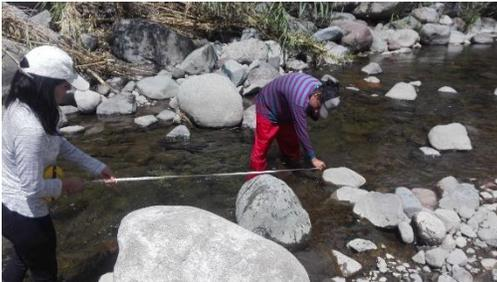
**Fotografía 3.** Medición de caudales en campo.
