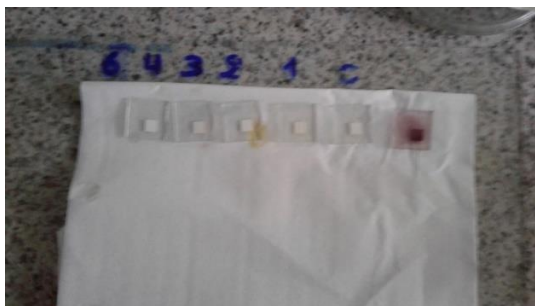
Figura 21: Secado de electrodos a temperatura ambiente
