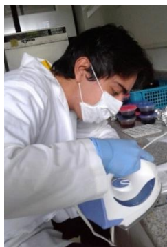
Figura 22: Sellado de la celda a 100° C
