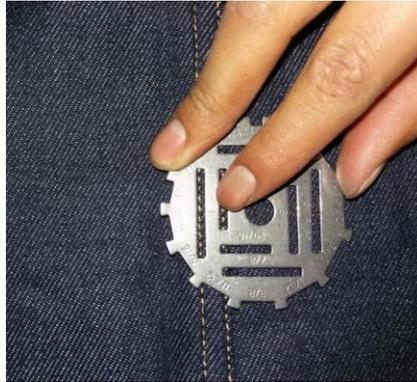
**Figura 28** Medición de puntadas
