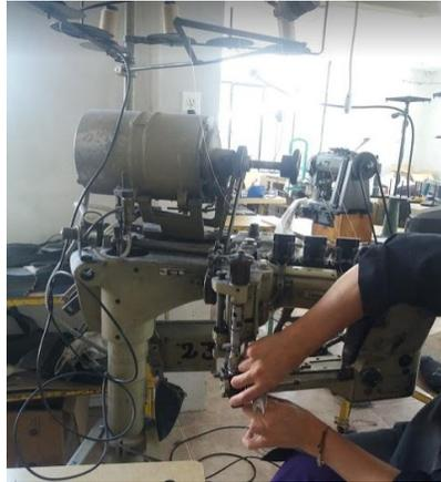
**Figura 26** Cambio de aguja e hilo de cerradora de codos
