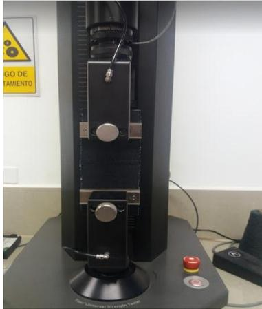
**Figura 30** Realización de prueba de resistencia y elongación en muestra
