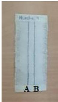
Figura 1. Muestra del tejido conductor. Hilos A y B
