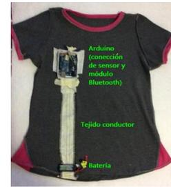
Figura3. Vista del revés de la camiseta. Distribución de los componentes electrónicos.
