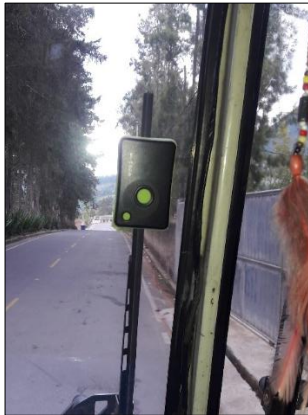
Fig. 6. Instalación del dispositivo GPS GL-770 en un bus
