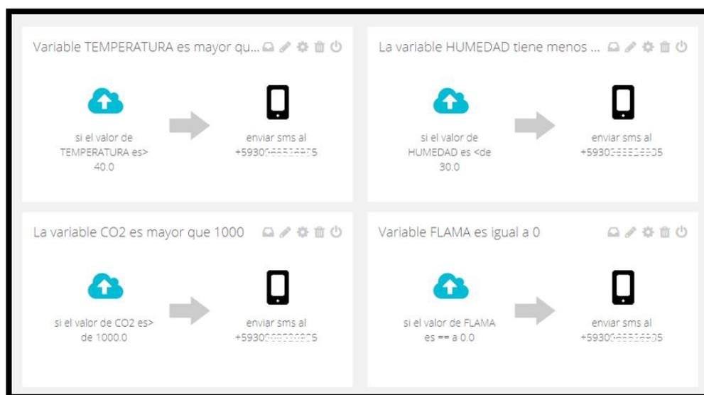
Figura 67: Configuración de los valores máximos de los sensores
