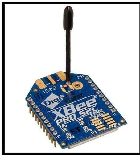
Figura 21 Modulo inalámbrico Xbee Por S2C
