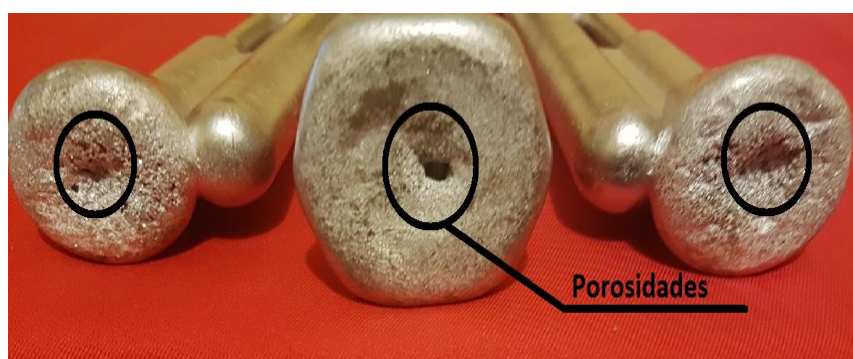
Figura 5.26. Comparación de porosidades copa de vaciado y mazarotas a) simulación b) pieza fundida
