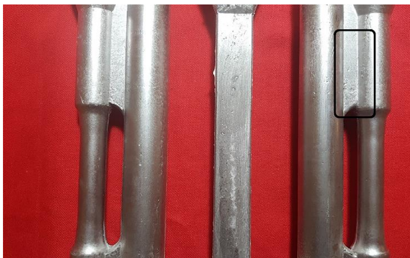
Figura 5.29. Comparación de porosidades en la parte superior de las mazarotas laterales a) simulación b) pieza fundida
