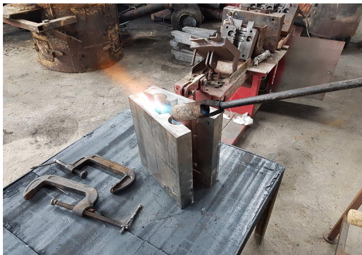
Figura 4.16. Pre calentamiento de la matriz a 450°C
