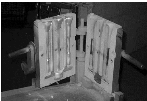
Figura 2.1. Molde permanente para probetas de A-A. Fuente: (Lumley, 2011, pág. 161).
