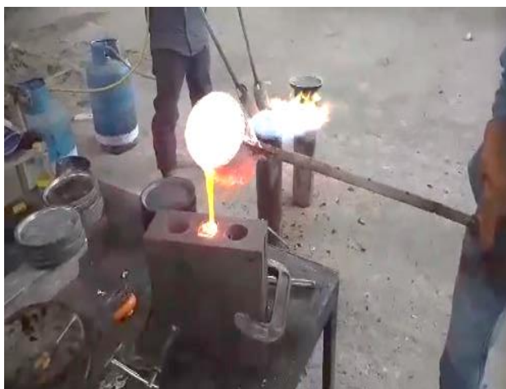
Figura 4.17. Vertido del metal fundido a 750°C
