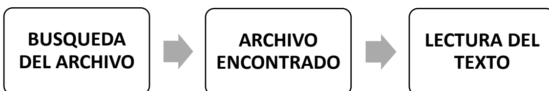
Figura 44: Diagrama de bloques opción buscar-leer archivo, funcionamiento del prototipo
