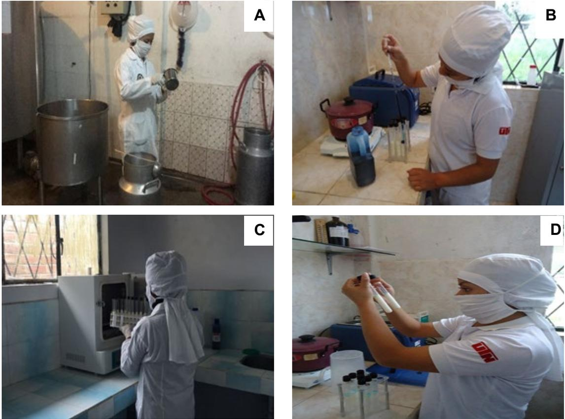
**Figura 16 (A)** Toma de muestra de leche, **(B)** preparación de muestra de leche para la prueba de reductasa y azul de metileno, **(C)** Muestras en la incubadora, **(D)** Lectura de los coágulos de lactofermentación.
