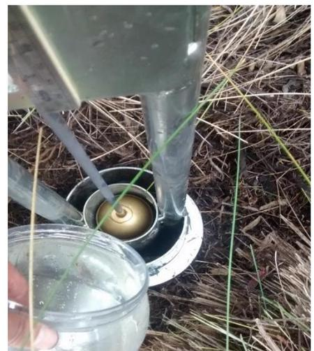
**h) Agua en el infiltrómetro**
