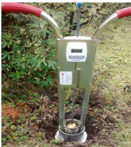
**g) Toma de datos con el infiltrómetro**
