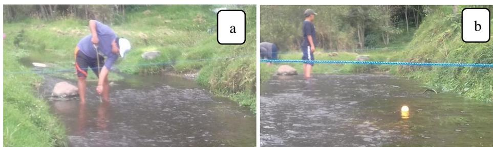
**Figura 2.** Medición de caudales por método de flotadores
