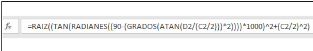
**Figura 2.46** Cálculo en Excel del radio de la curva
