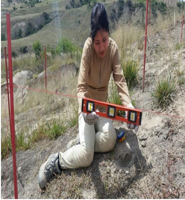
Figura 7. Medición de pendientes de los tres ensayos de clavos de erosión.
