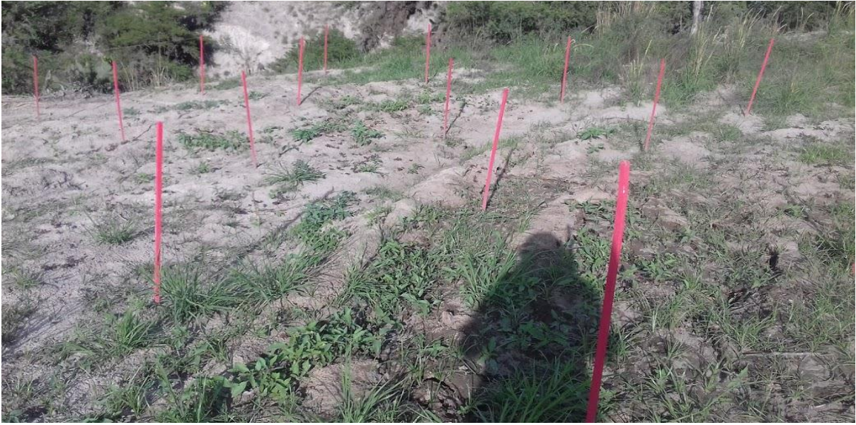
Figura 3. Ensayo de clavos de erosión cuadrante 1.
