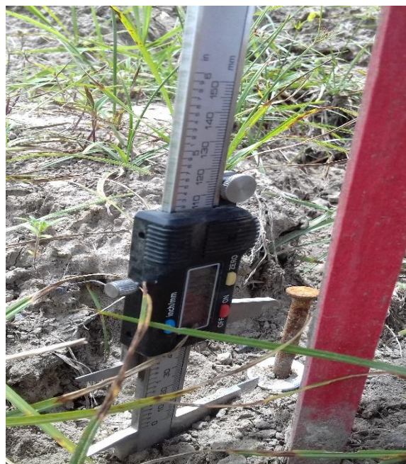
Figura 6. Medición de la erosión hídrica, en el cuadrante 1.
