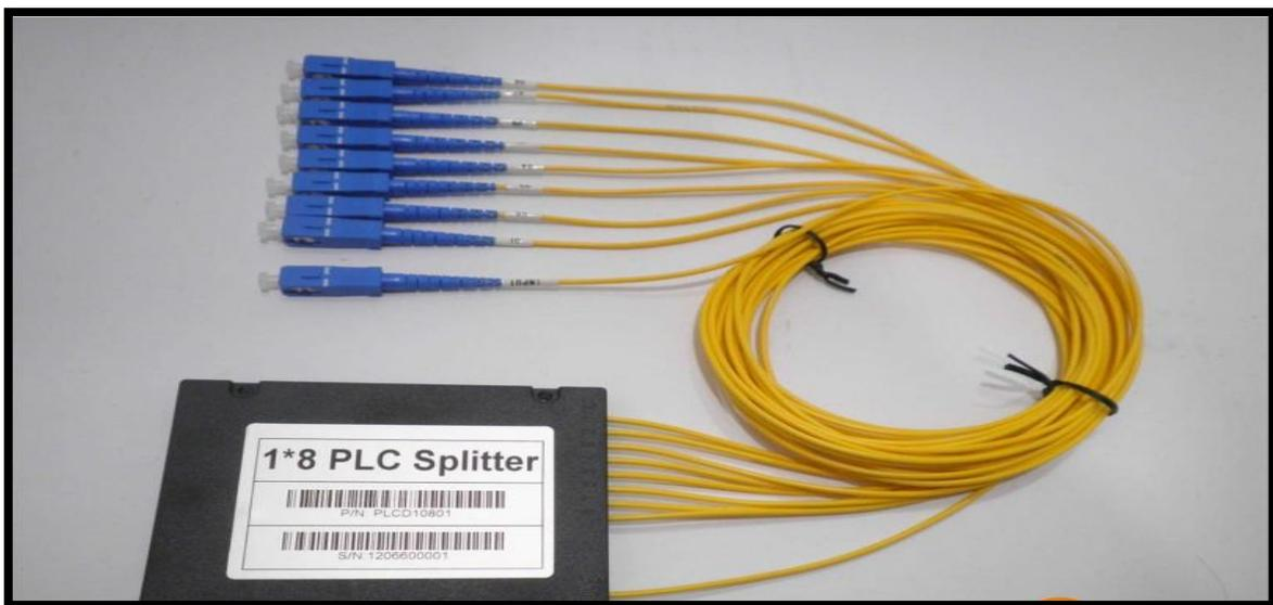
*Figura 7: Splitter para una Fibra Óptica.*
