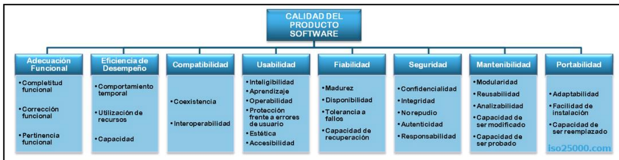
Figura 37 Modelo de calidad del producto definido por la ISO/IEC 25010 Fuente: (“ISO/IEC 25010”, 2019)
