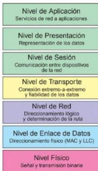
*Figura 5.* Capas del modelo OSI
