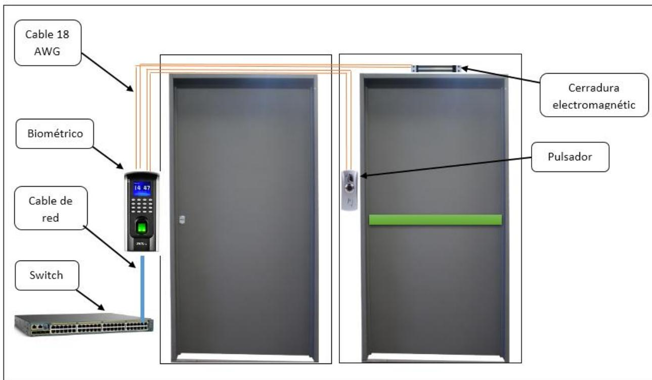
Figura 44. Diagrama de conexión del Biométrico
