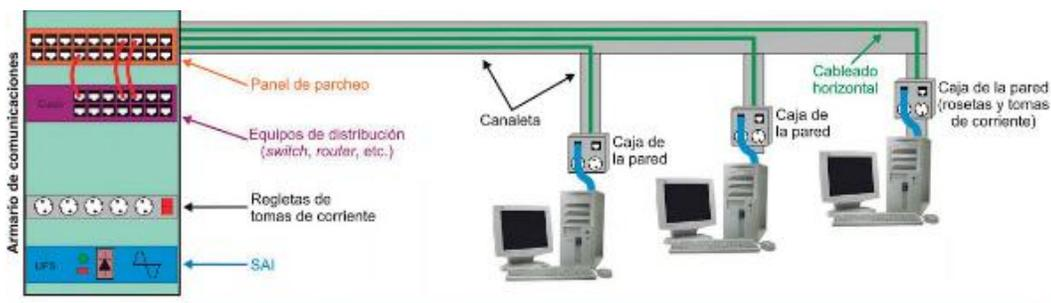
Figura 12. Cableado horizontal
