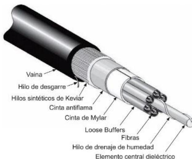
Figura 8. Cable de fibra óptica
