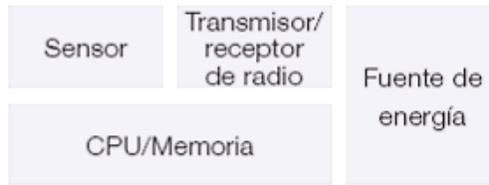
Figura 11. Componentes de un dispositivo autónomo.
