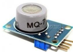
Figura 4. Sensor MQ-7 de Monóxido de Carbono
