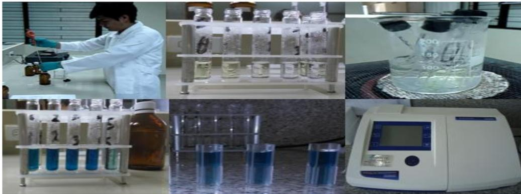
**Figura 16.** Proceso de cuantificación por espectrofotometría
