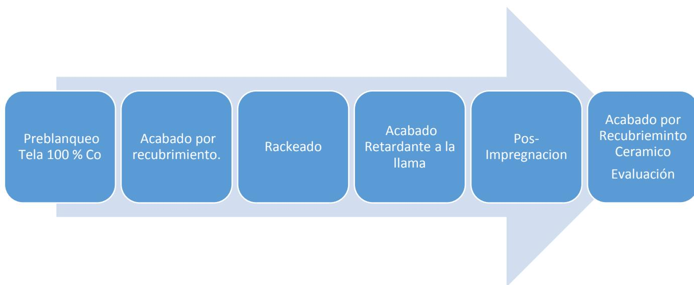
*Figura 17.* Proceso del Acabado por recubrimiento cerámico.
