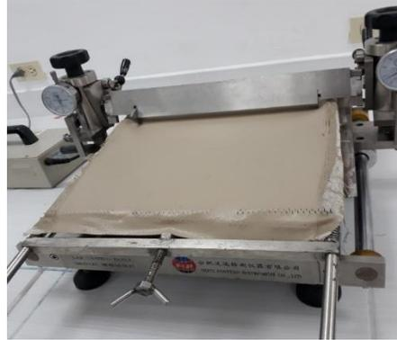
*Figura 30 .Máquina de Rackeado.*
