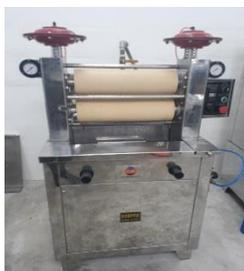
*Figura 15.* Foulard de Laboratorio.
