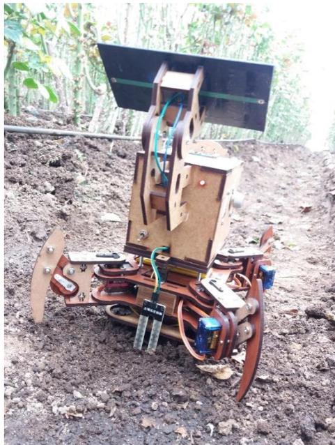
Figura 33. Sensor de humedad del suelo ubicado en la parte trasera e inferior del robot FarMi4
