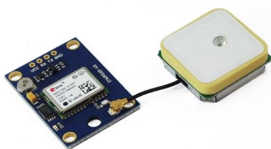
Figura 22. Módulo GPS Neo 6M
