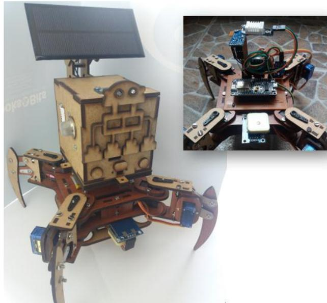
Figura 32. Placa base de sensores ubicada en la parte superior del robot FarMi4
