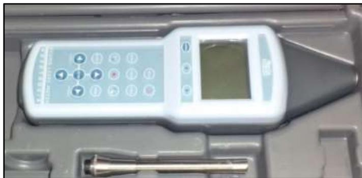
**Figura 3.** Sonómetro utilizado en la medición
