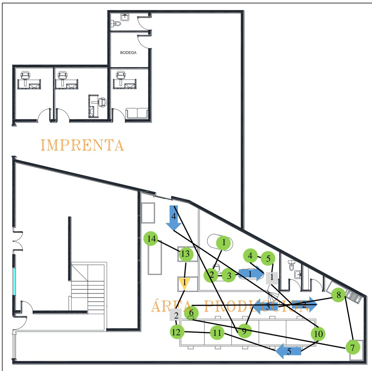
*Figura 22. Diagrama de recorrido de la línea de producción*
