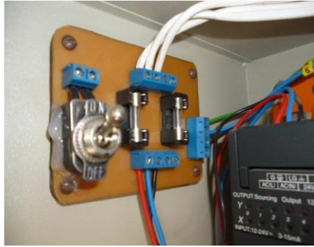
*Figura 2.36.* Placa de Alimentación: Controlador y Fuente de Voltaje de 24 V.
