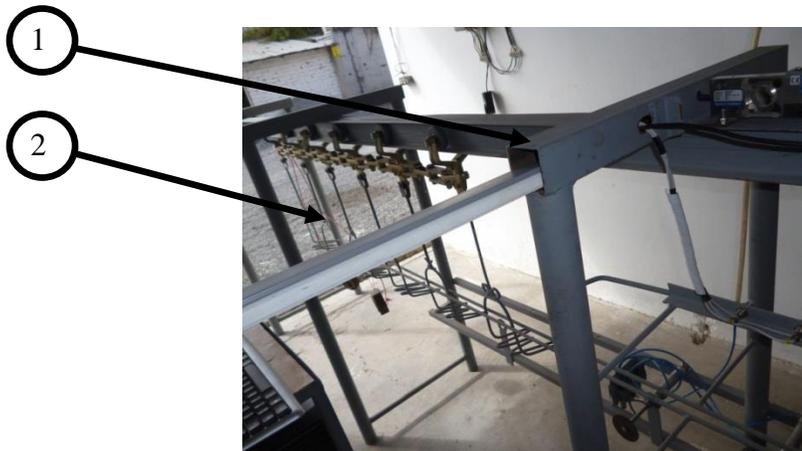
*Figura.* Identificación de elementos, riel y cadena transportadora.
