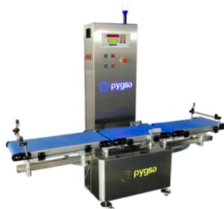
*Figura 1.8. Sistema de Pesaje Dinámico. [10]*
