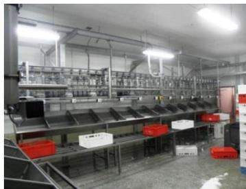
*Figura 1.5.* Sistema Automático de Pesaje y Clasificación de Pollos. [5]
