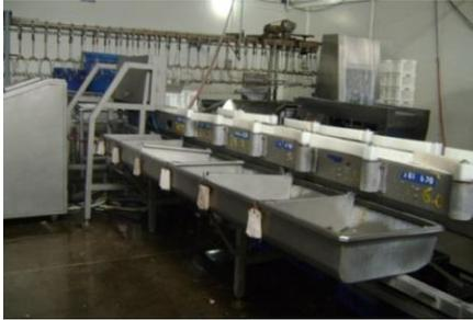
*Figura 1.4.* Sistema Semiautomático de Pesaje y Clasificación de Pollo.
