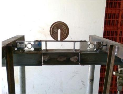
*Figura 3.1.* Pruebas de Construcción del Puente de Pesaje.
