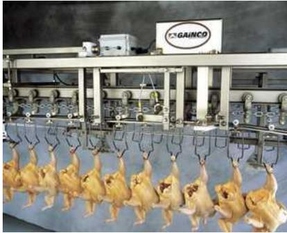
*Figura 1.10.* Sistema Clasificador por Pateadores Neumáticos. [13]
