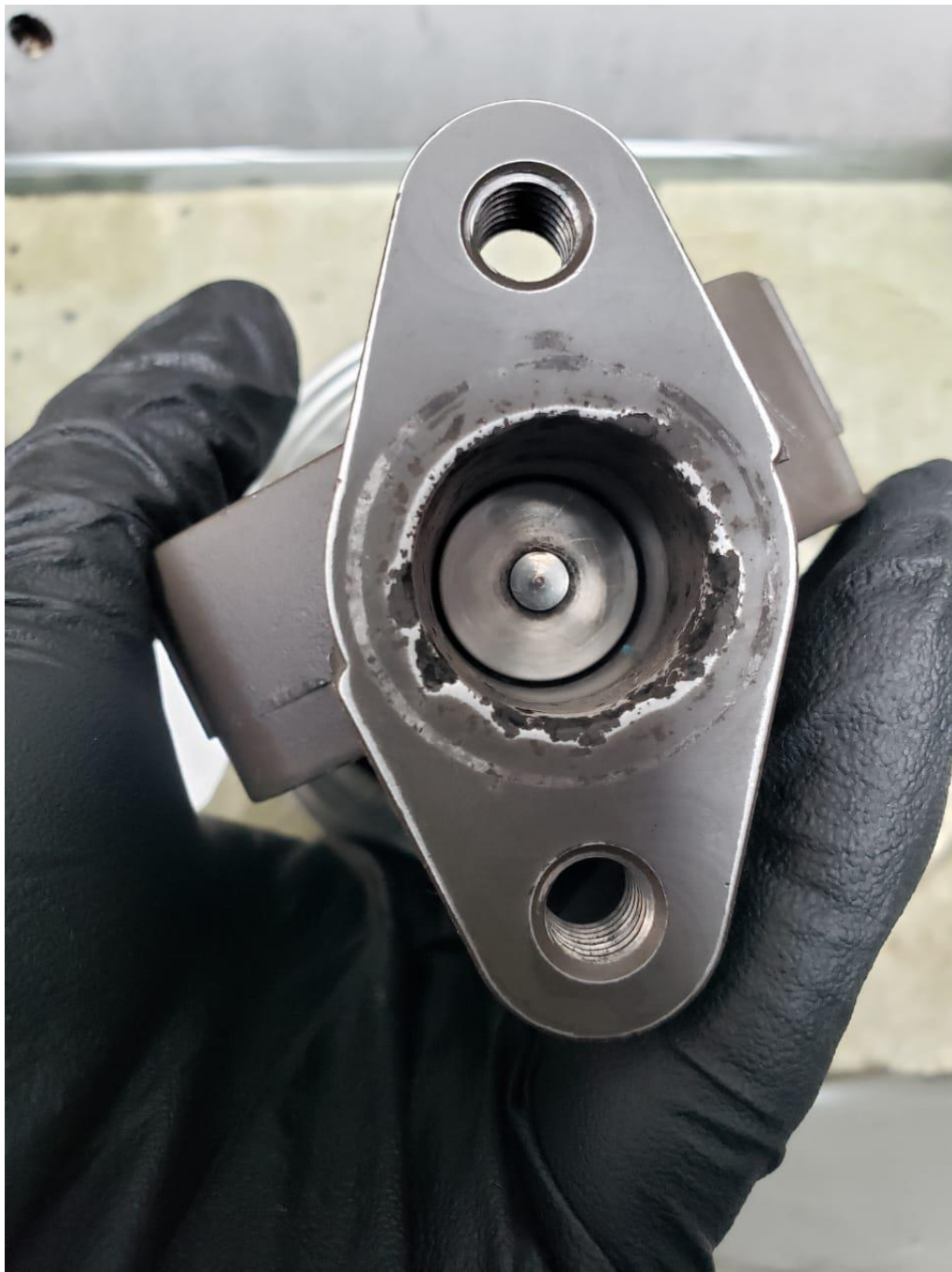
Figura A1V.4 Válvula desgastada
