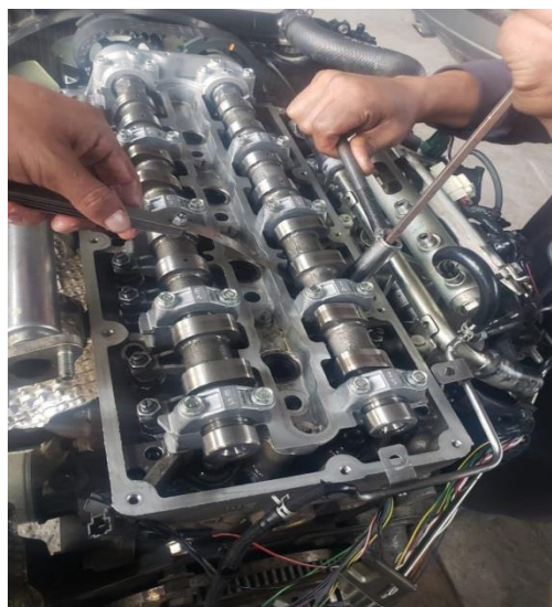
Figura 3.1 Calibración de válvulas (TALLERES SID, 2018)
