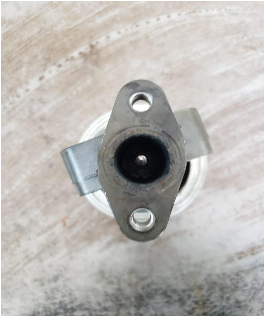
Figura A1.1 Válvula EGR Obstruida
