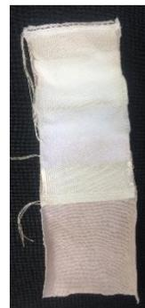
Ilustración 55. Muestra tinturada después de la prueba de lavado
