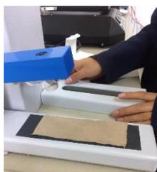
*Ilustración 63.* Prueba de solidez al frote
