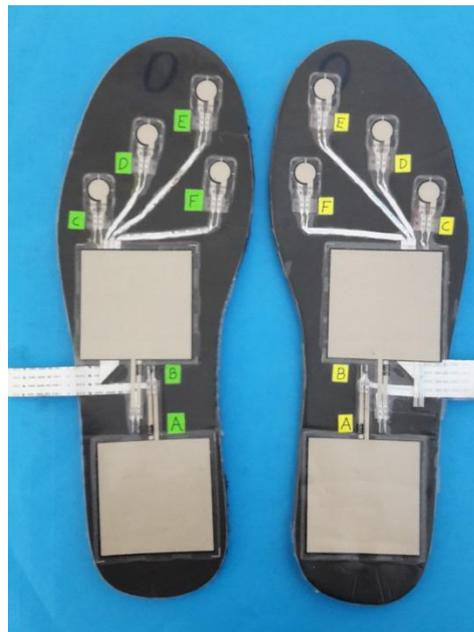
*Figura 33.* Plantillas de zapato donde se fijan los sensores.
