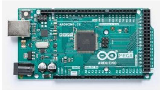
**Figura 18.** Tarjeta electrónica Arduino Mega 2560
