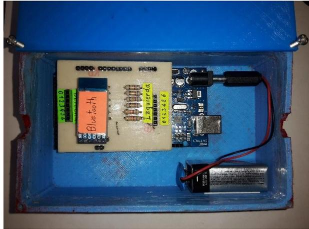
**Figura 34.** Caja portadora de la tarjeta Arduino y el circuito de acondicionamiento.
