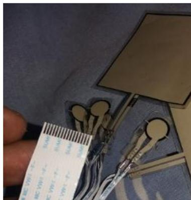
**Figura 25:** Conexión de sensores con el cable FFC.
