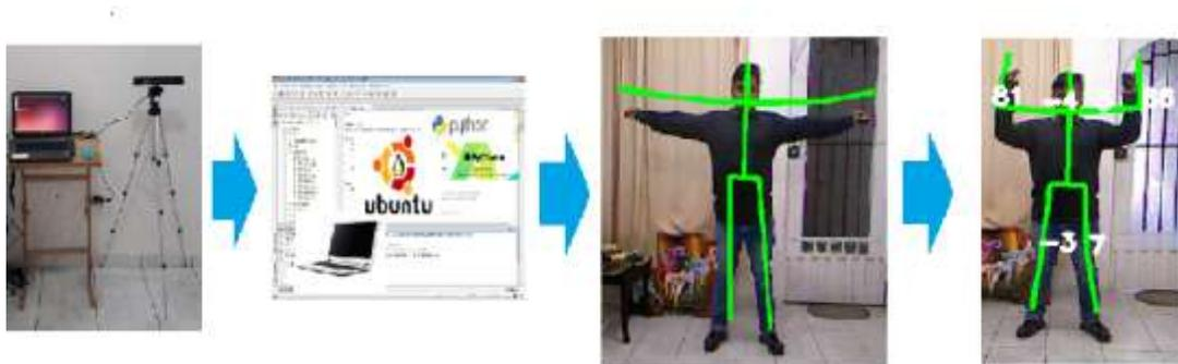
Diagrama de Flujo 3.1. Diagrama del sistema de trabajo
