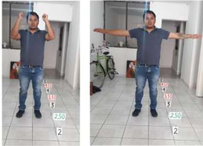
Figura 6.2. Distancia de 2.50 metros entre cámara de profundidad y usuario
