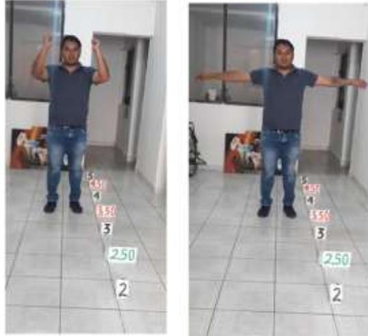
Figura 6.4. Distancia de 3.50 metros entre cámara de profundidad y usuario
