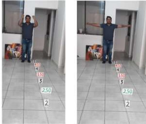
Figura 6.7. Distancia de 5 metros entre cámara de profundidad y usuario
