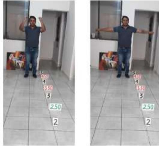
Figura 6.6. Distancia de 4.50 metros entre cámara de profundidad y usuario
