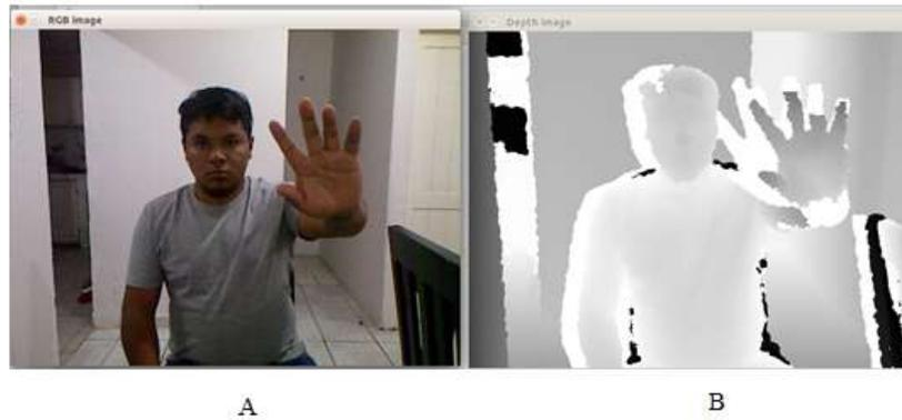
Figura 3.6. A. Imagen RGB, B. Imagen con profundidad
