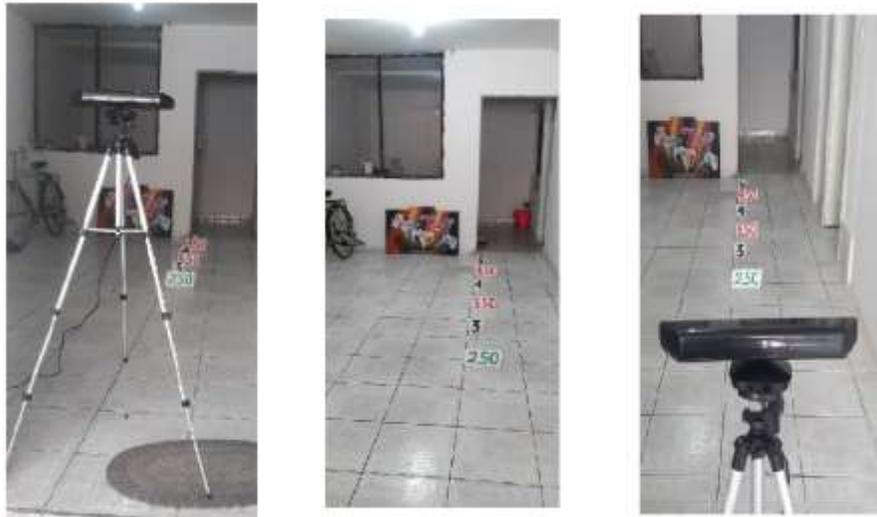
Figura 4.1. Distancias para la toma de imágenes de prueba de funcionamiento
