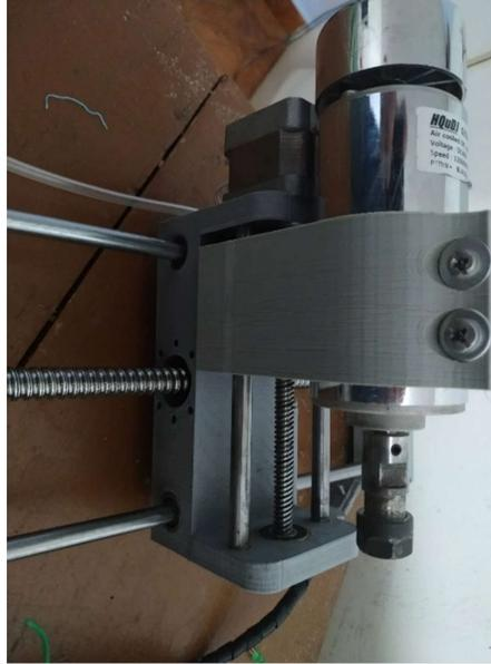
*Figura 36: Ensamblaje del eje z.*
