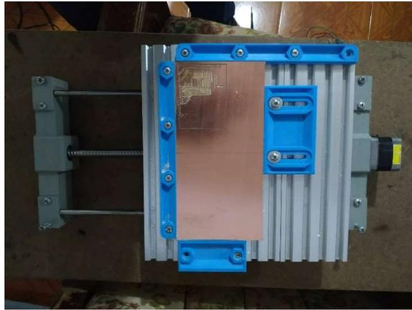
*Figura 38: Ensamblaje total de eje y.*
