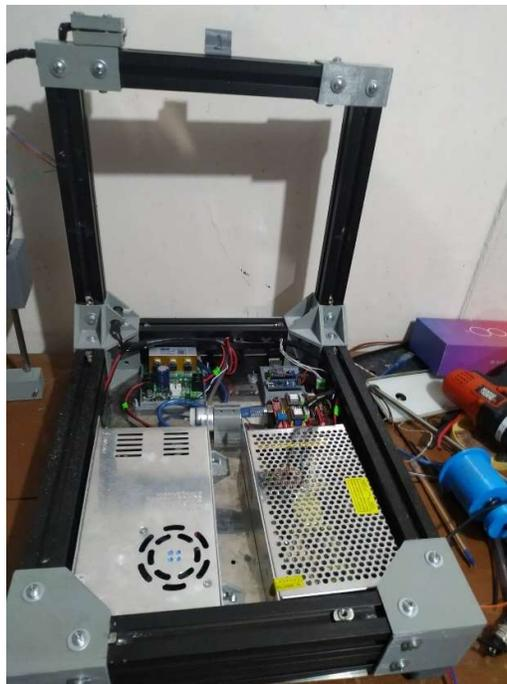
*Figura 39: Ensamblaje de la estructura de aluminio.*
