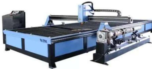
*Figura 6: Cortador de plasma CNC.*
