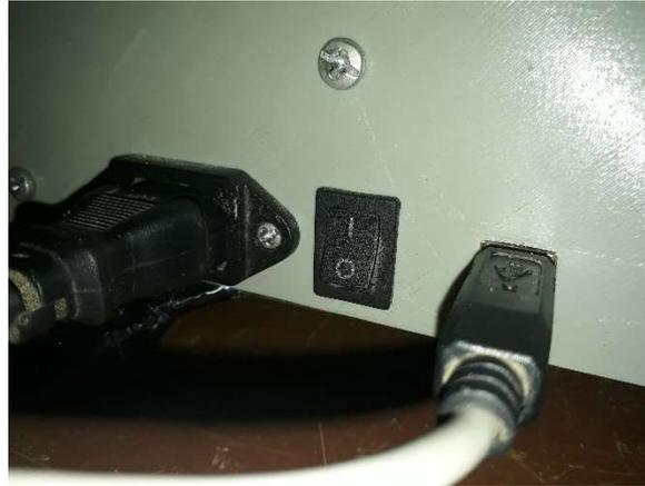
Figura 1. Tablero de encendido y conexión de la máquina
