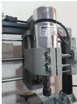
*Figura 38: Cabezal de ruteado y taladrado.*
