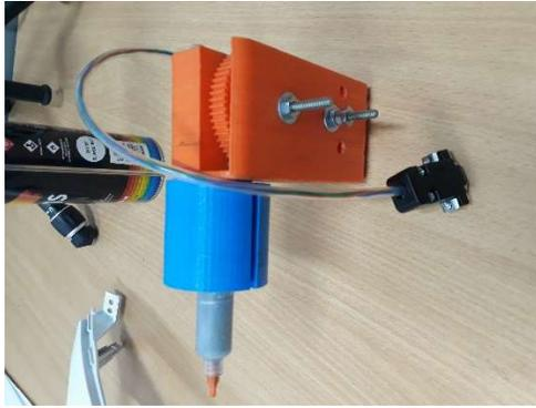
*Figura 39: Cabezal de dispensación de pasta.*
