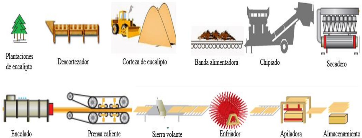
Figura 1. Proceso de elaboración del panel
