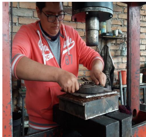
Ilustración 8. Prensado de panel
