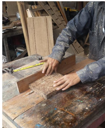
Ilustración 12. Dimensionado de probetas
