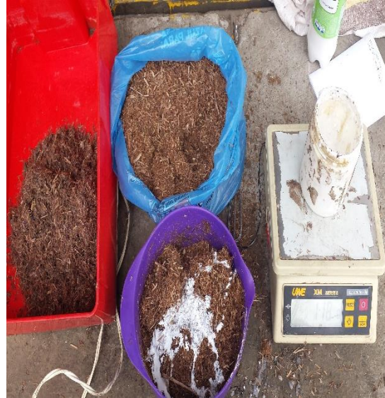
Ilustración 6. Mezcla de ingredientes para elaboración de panel
