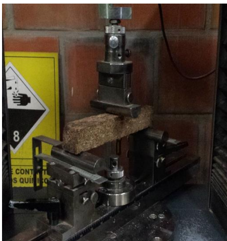
Ilustración 13. Ensayo de flexión
