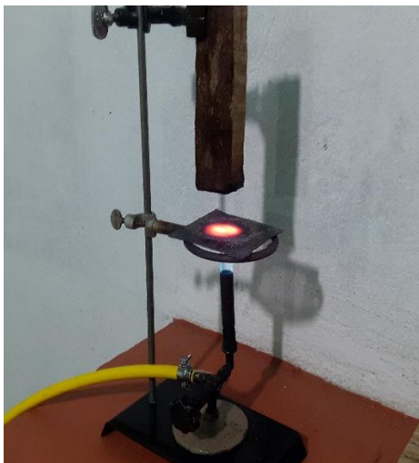
Ilustración 19. Ensayo de fuego
