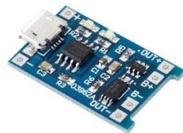
Figura 44. Módulo de Carga TP4056 Fuente: Datasheet Modulo TP4056 – 18650
