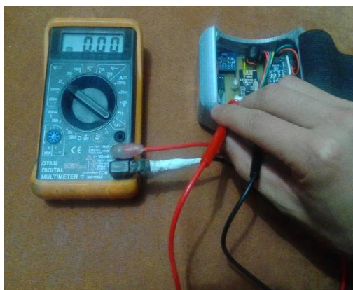
Figura 72. Medición con Multímetro Fuente: Autoría
