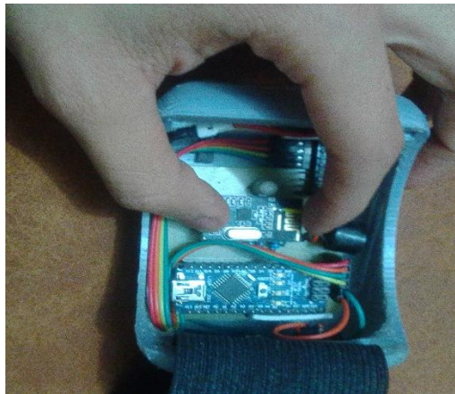
Figura 87. Finalización de Armado de Tobillera Fuente: Autoría
