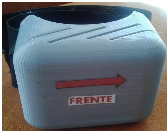
Figura 46. Modulo Tobillera para Toma y Procesamiento de Datos Fuente: Autoría
