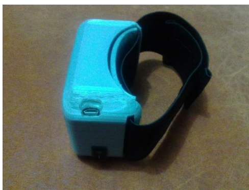
Figura 73. Puerto de Carga de Tobillera Fuente: Autoría
