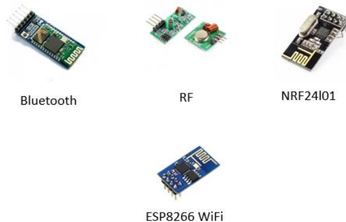
Figura 13. Módulos de Comunicación Inalámbrica en arduino Fuente: Autoría
