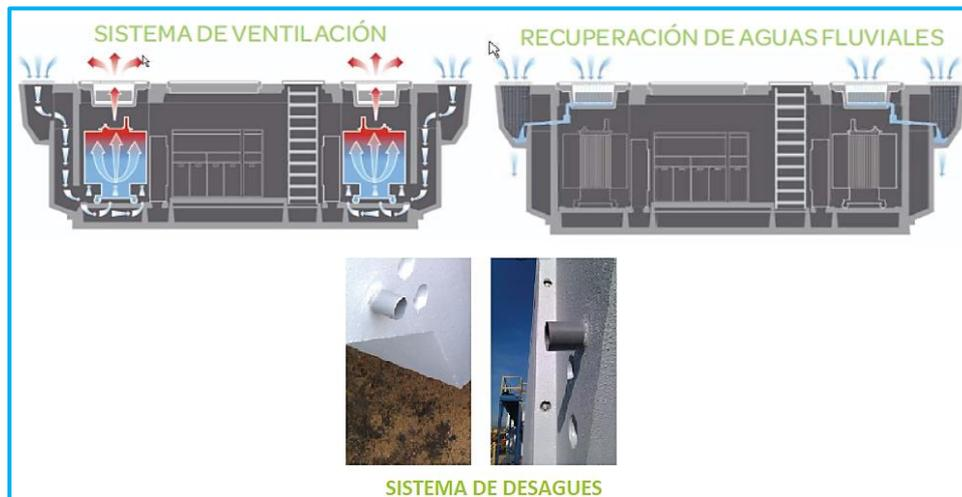
Fig. 2.28 Sistema de ventilación, recuperación de aguas fluviales y desagües.
