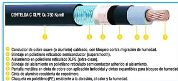
Fig. 1. 20 Estructura de un conductor de medio voltaje tipo XLPE.
