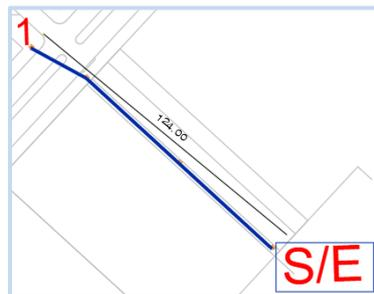
Fig. 2.51 Recorrido del alimentador B desde la subestación Yachay hasta el punto 1.
