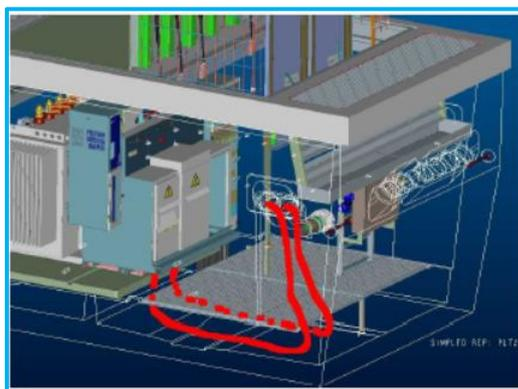
Fig. 2.39 Instalación del conductor.
