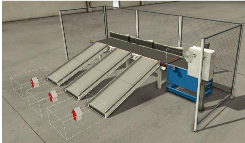
Figura A5.1 Clasificación de cajas basadas en peso
