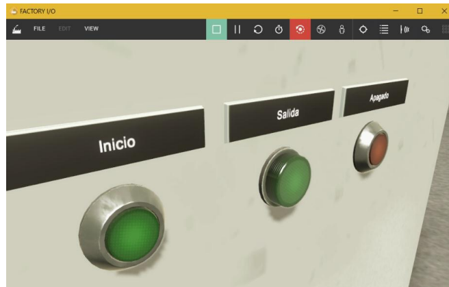
Figura 2.31 Tablero de control implementado en Factory I/O
