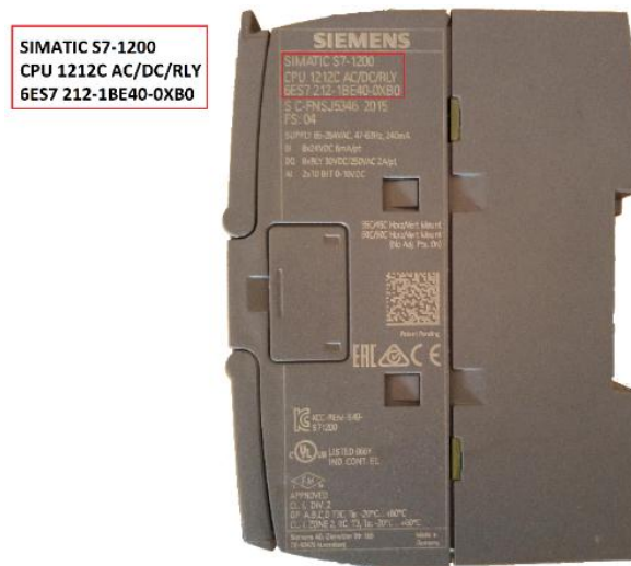
Figura 2.5 Código del modelo del PLC S7-1200
