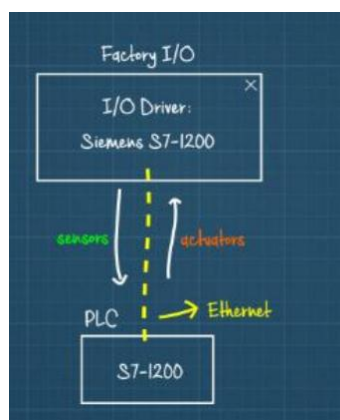
Figura P.4 Esquema de comunicación entre FACTORY I/O y TIA PORTAL
