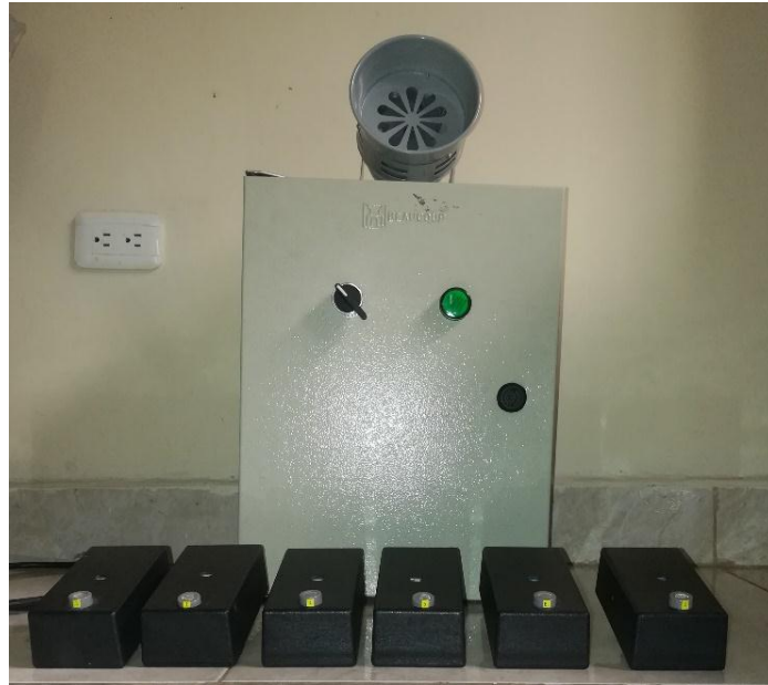
Fig. 2.36. Detectores de humo y módulo de control Fuente: Autor
