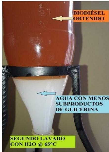
**Figura 2. 18** Segundo lavado del biodiésel B100
