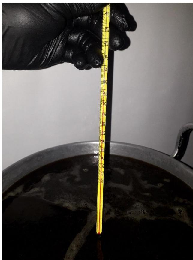
**Figura A.II. 4** Proceso evaporación de agua del aceite reciclado entre 90°C a 100°C
