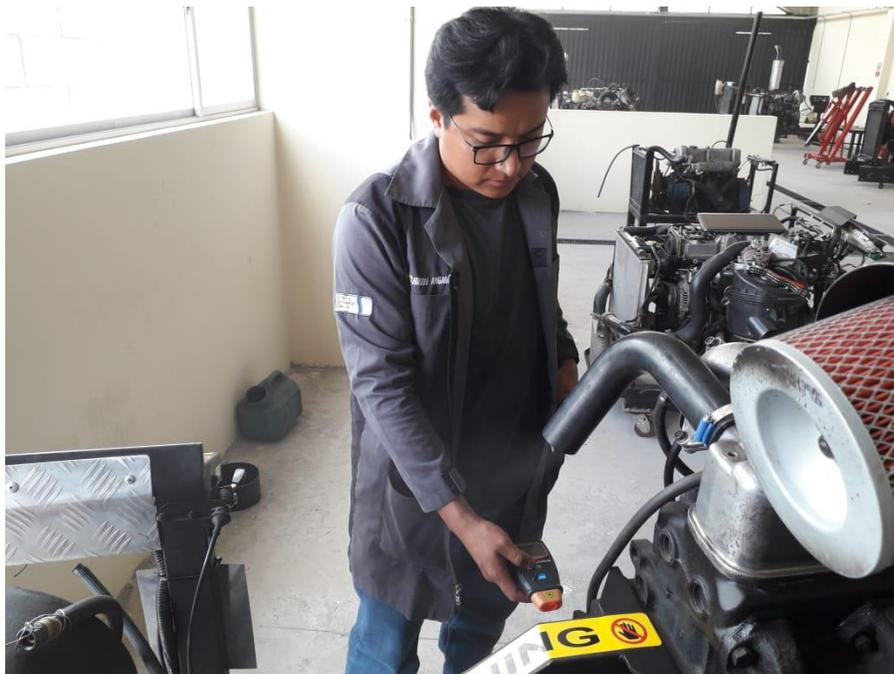
**Figura A.III. 2** Verificación estado de rpm
