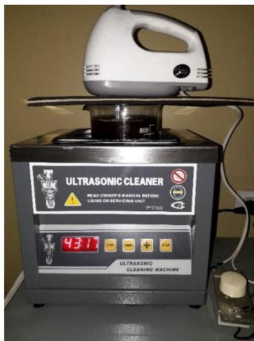
**Figura 2. 15** Proceso de Transesterificación en baño ultrasónico
