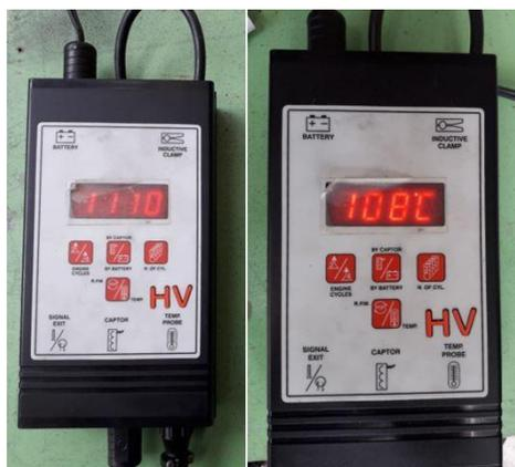
**Figura 2. 21** Contador de revoluciones y medidor de temperatura motor MGT-300
