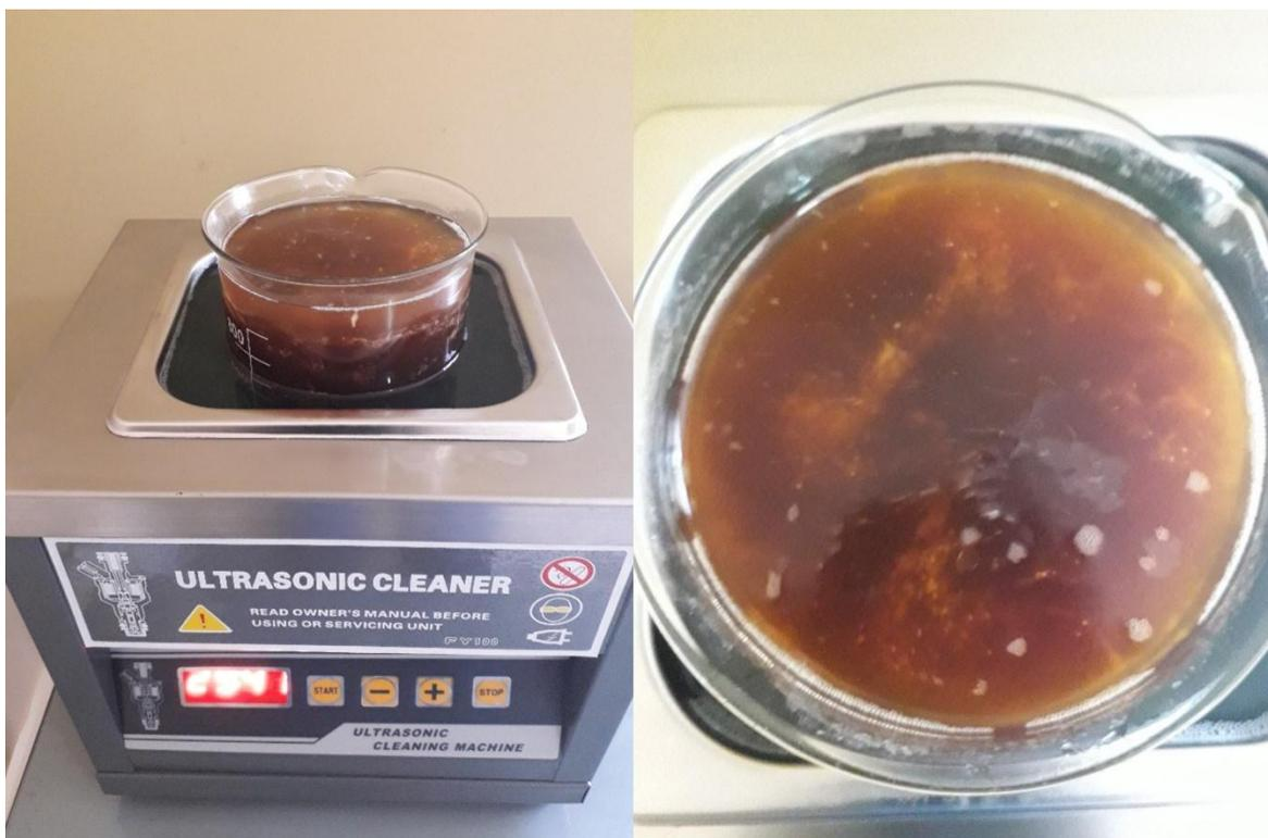
**Figura A.II. 7** Aplicación de frecuencia ultrasónica a 45 kHz constante
