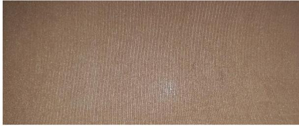
**Figura 2. 5** Tela filtrante compuesta de 88% nylon y 12% elastano
