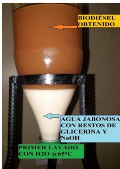
**Figura 2. 17** Primer lavado del biodiésel B100
