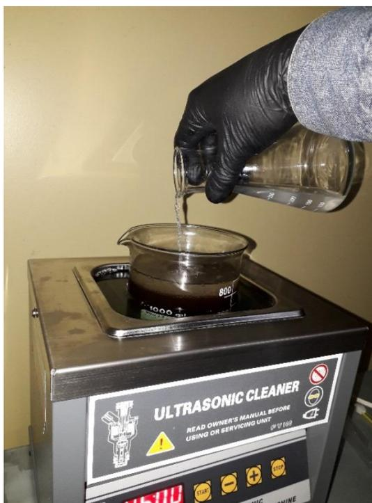
**Figura A.II. 6** Miscelánea de metóxido sódico con aceite reciclado de cocina
