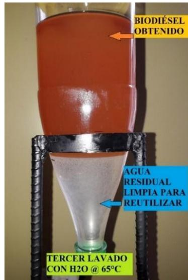
**Figura 2. 19** Tercer lavado de biodiésel B100
