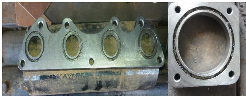
Figura 2.24 Placa de sujeción y base para el cuerpo de aceleración
