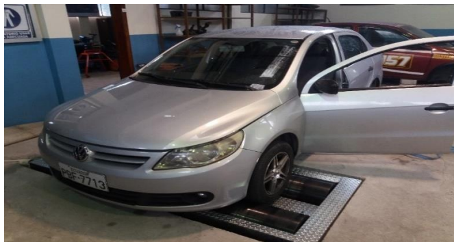
Figura 2.31 Vehículo de pruebas ubicado en el dinamómetro
