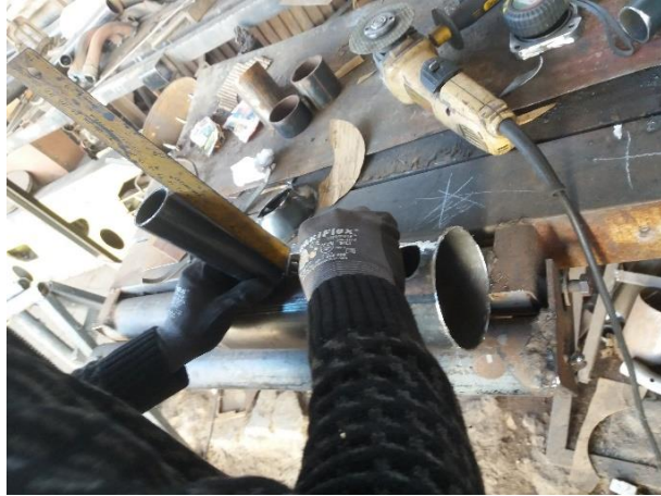
Figura 2.25 Proceso de fabricación del múltiple de admisión
