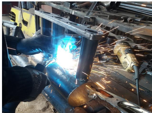
Figura 2.26 Soldadura del múltiple de admisión
