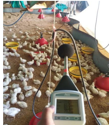
Anexo 14. Medición de Niveles de Ruido con el Sonómetro Digital en los Galpones N°1 y N°2 de Crianza de Pollos BB
