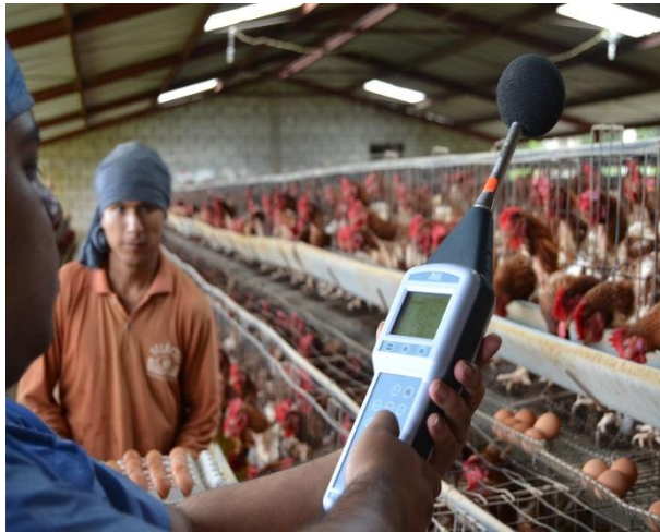
Anexo 5. Medición de los niveles de Ruido con el Sonómetro Digital en el Galpón N° 2 de Gallinas Ponedoras
