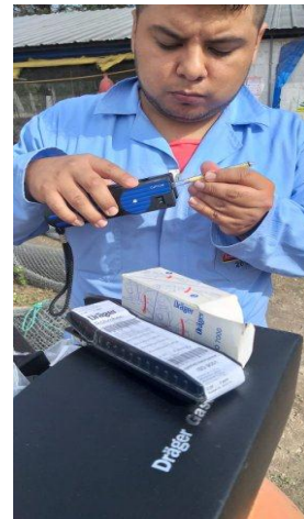
Anexo 16. Calibración y Verificación de Equipo Bomba Draguer que sirve para Medir la Concentración de Amoniac (NH 3 ) dentro de los Galpones
