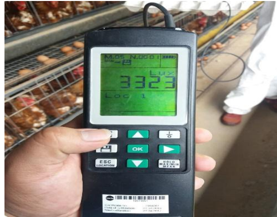
Anexo 10. Medición de los Niveles de Iluminación con el Instrumento Luxómetro en el Galpón N° 2 de Gallinas ponedoras
