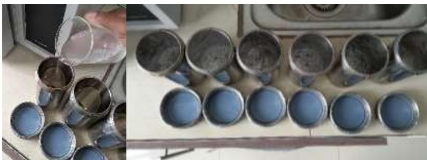
*Ilustración 21. Vertido 150 ml de solución en cada vaso de acero inoxidable.
