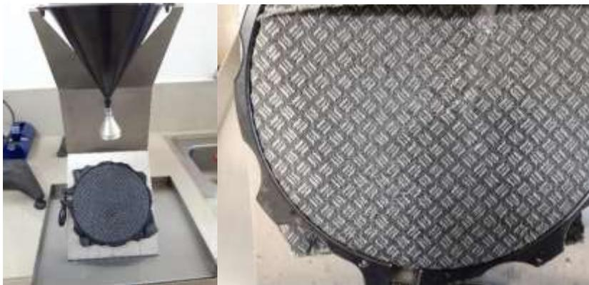
*Anexo 12. Valoración 0 de repelencia al agua, después de lavado acelerado
