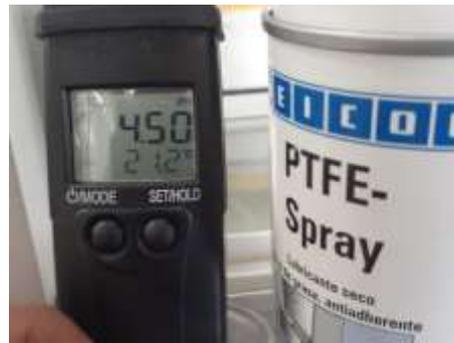
*Ilustración 6 Medición de pH de PTFE*
