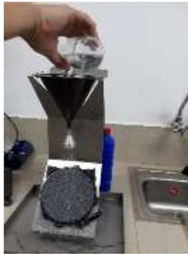
*Ilustración 15 Vertido 250 ml de agua destilada en el embudo.*
