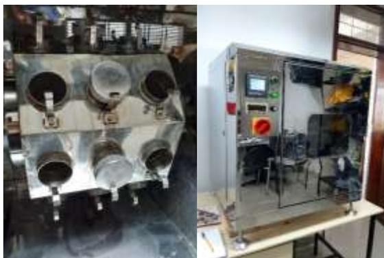
*Ilustración 24. Cargado de vasos en la máquina y arrancado con el programa adecuado para lavado acelerado.
