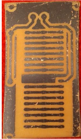
Figura 109: Pistas ruteadas de la conexión de los pulsadores en resistencia pull - up impresas en papel FUENTE: Autoría
