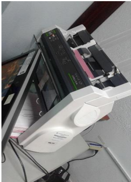
Figura 25: Impresora Braille (Index-everest D) Fuente: UTN
