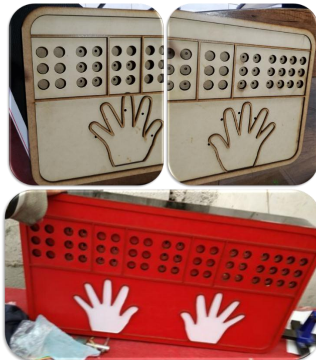
Figura 113: Elaboración de la tapa principal en madera para sistema electrónico
