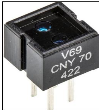
Figura 50: Sensor Infrarrojo CNY70
