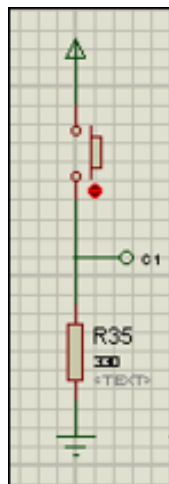
Figura 105: Pulsadores con resistencia modo Pull – Down
