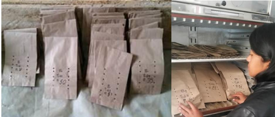
Figura 10. Muestras en fundas codificadas y colocación en el horno a 65°C.
