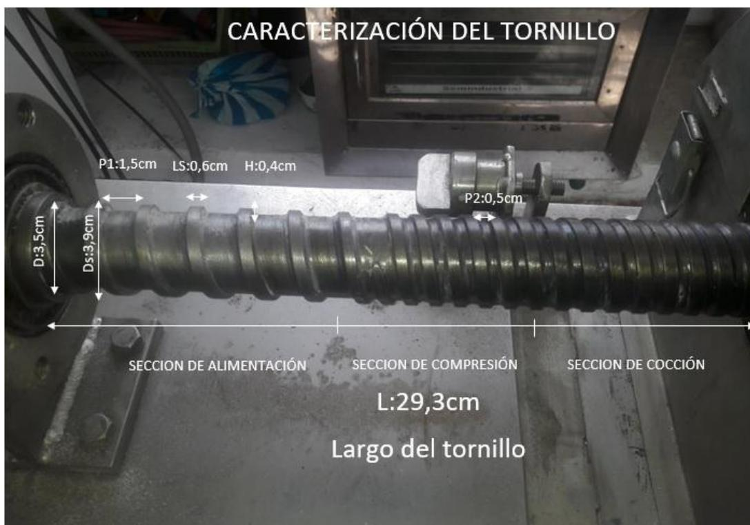
Figura 18 Caracterización del tornillo (INIAP, 2019)
