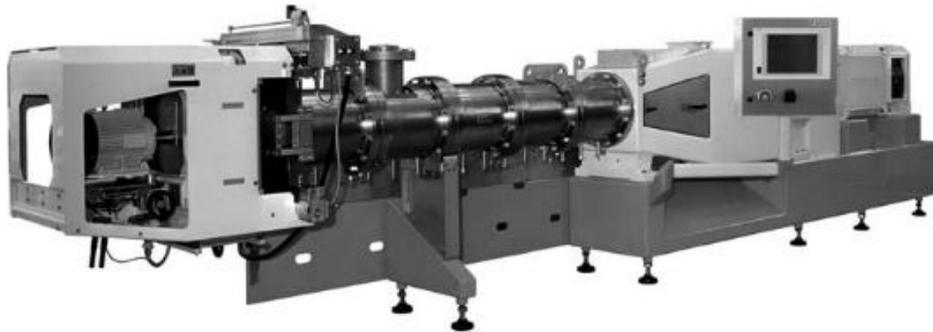
**Figura 3** Extrusora moderna de doble tornillo tipo BCTA
