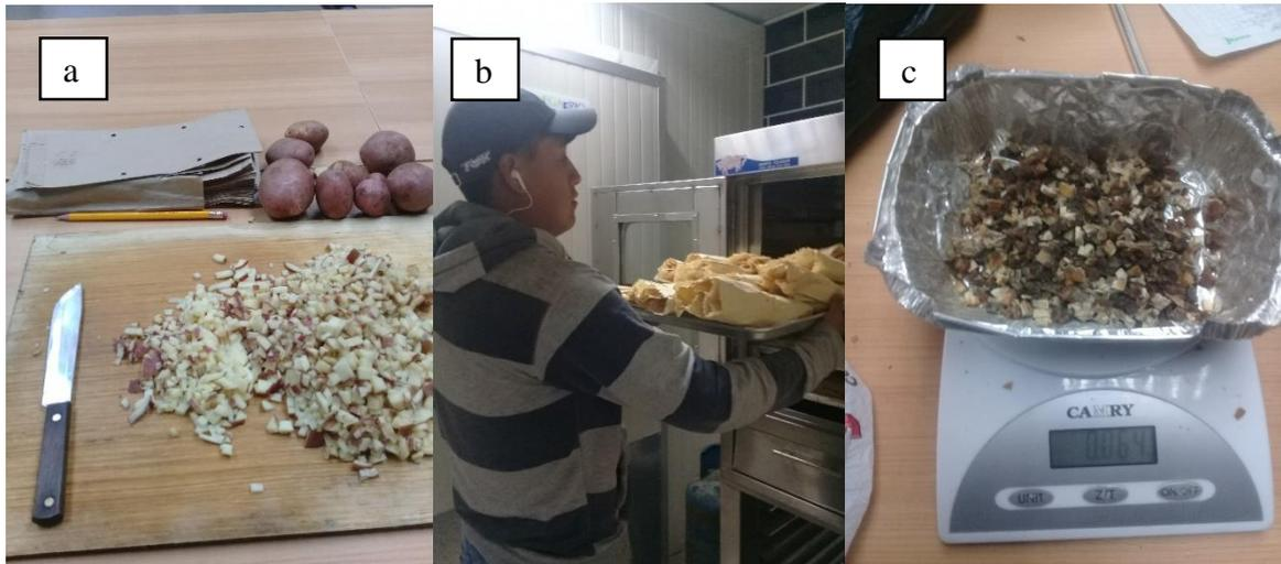
Figura 7. Materia seca de tubérculos. a) Peso fresco de tubérculos. b) Secado de tubérculos. c) Peso seco de tubérculos.
