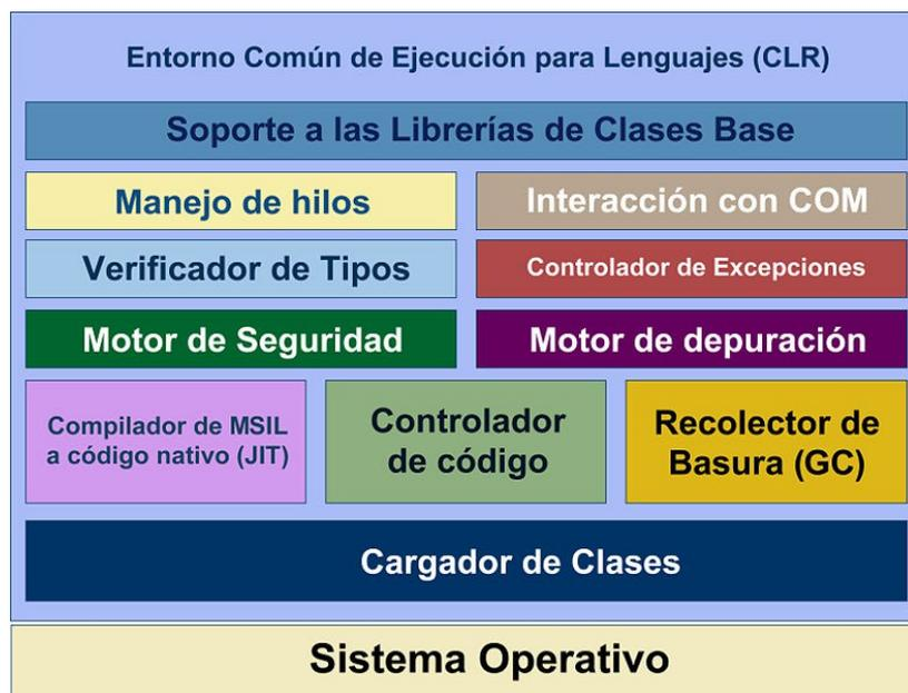
*Ilustración 24: Diagrama interno del Entorno Común de Ejecución para Lenguajes (CLR)*
