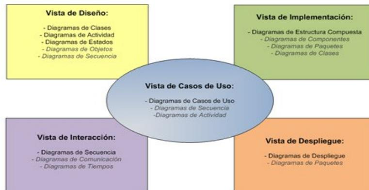
*Ilustración 4: Vista arquitectónica UML*
