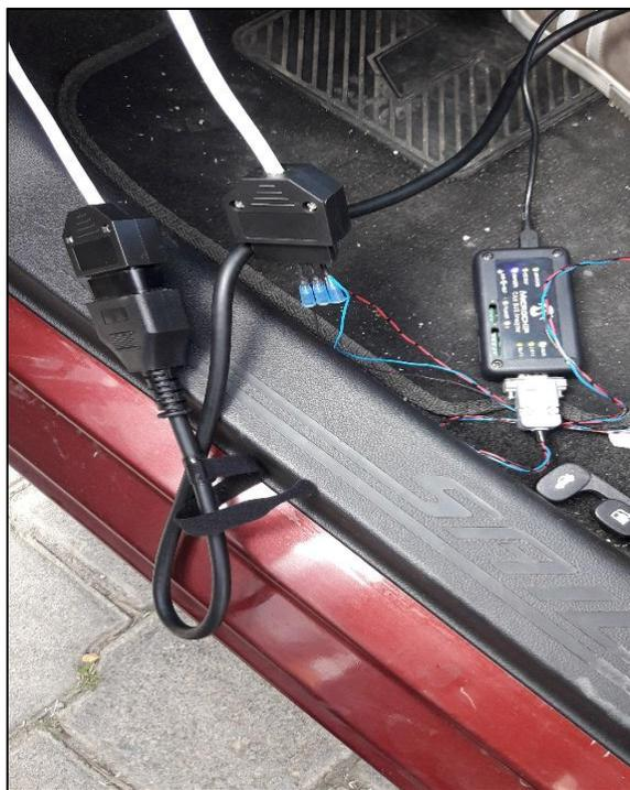
**Figura 2. 11** Conexiones para el proceso de filtrado de códigos.
