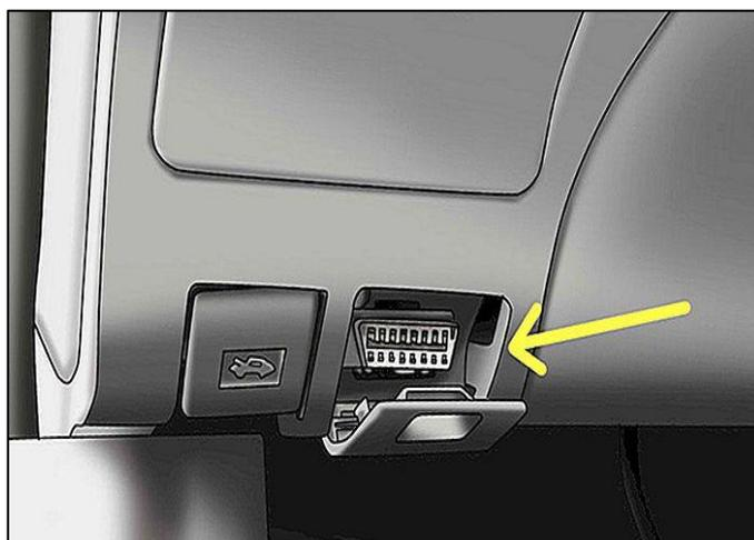
**Figura 1. 5** Conector DLC en el vehículo.
