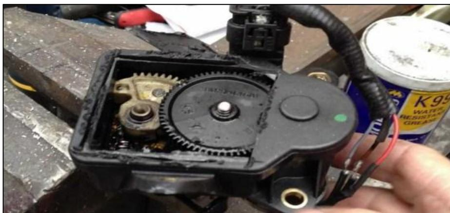
**Figura 1. 3** Motor Eléctrico cuerpo de aceleración.
