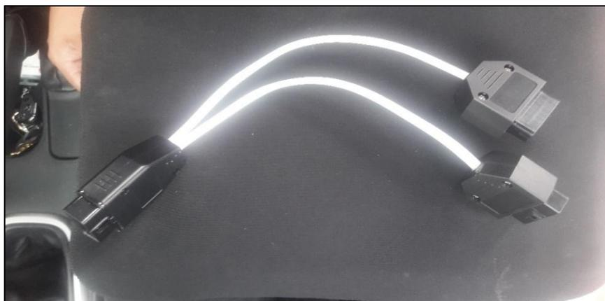
**Figura 3. 30** Cable adaptación puerto DLC.
