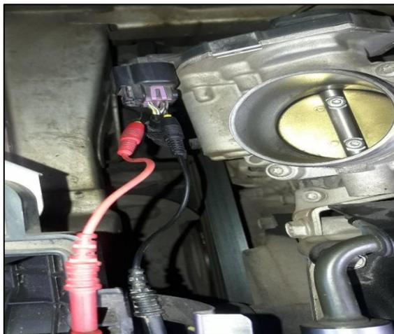
**Figura 3. 1** Conexión cables de señal TAC.
