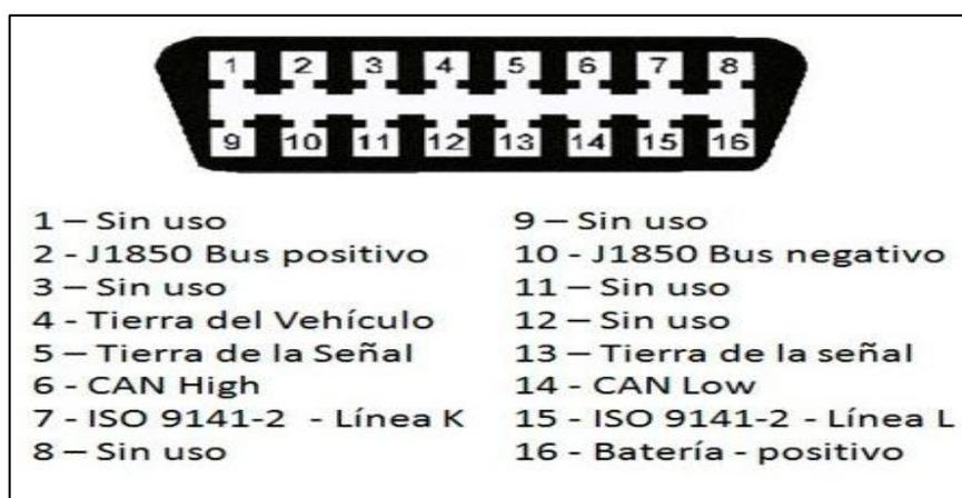
**Figura 1. 6** Terminales del conector DLC para OBD II.
