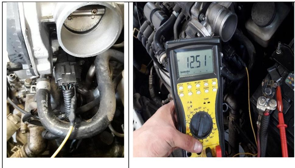
**Figura 3. 26** Pruebas y obtención de señales en el TPS.
