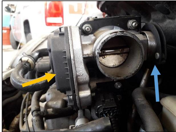
**Figura 3. 24** Cuerpo de aceleración Spark.
