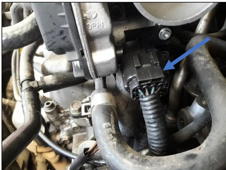
**Figura 3. 25** Socket de cables cuerpo de aceleración.
