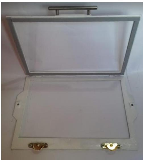
Ilustración 54. Bastidor de sujeción. Fuente: Autor (Romo Jimmy).
