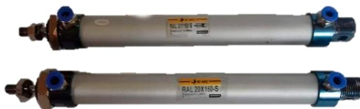
Ilustración 58. Cilindros RAL 20x150-s E-mc. Fuente: Autor (Romo Jimmy).
