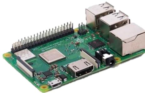
Ilustración 33. Raspberry Pi 3 Model B. Adaptado de Raspberry Pi 3 Model B+, análisis. Recuperado de: [www.xataka.com](http://www.xataka.com)
