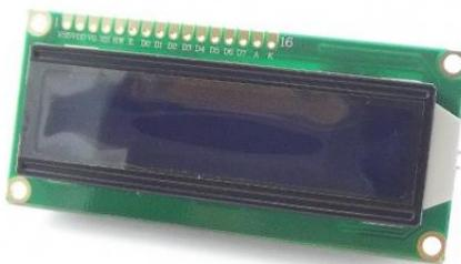
Ilustración 38. LCD1602 Adaptado de Tutorial LCD, conectando tu Arduino a un LCD1602 y LCD2004. Recuperado de: [www.naylampmechatronics.com](http://www.naylampmechatronics.com)
