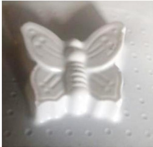
Ilustración 63. Termoformado aceptable de las muestras. Autor (Romo Jimmy).
