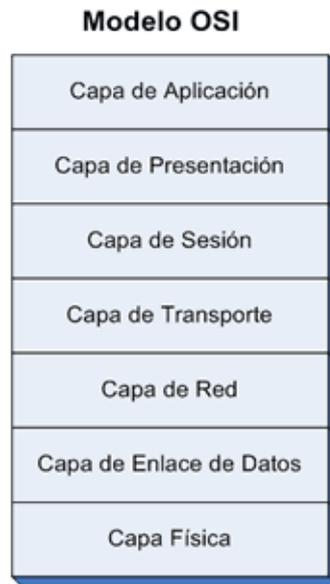
**Figura 17. Capas del Modelo OSI [52]**
